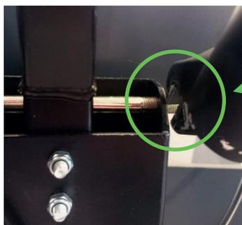
La face intérieure des pattes de fourche ne doit présenter aucun relief au contact de la surface plane de la tôle
